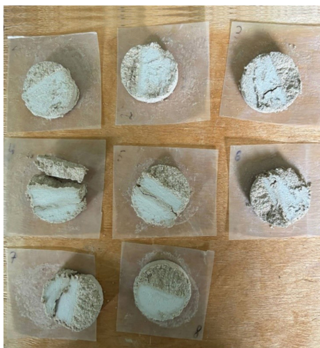
Рис. 4. Разрезанный по сегментам образец для последующих измерений влажности.
