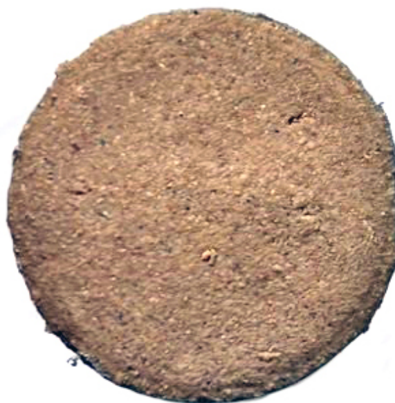
Рис. 2. Образец из смеси песка и солевого раствора после перемешивания до однородного состояния (вид сверху).
