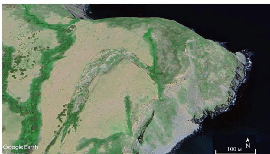
Рис. 1. Гигантская оползневая трещина отрыва на севере о. Шикотан, вызванная землетрясением, недалеко от пос. Малокурильское: (a) вид сверху (фото В.М. Кайстренко, 1995 г.), (b) вид изнутри (фото А.О. Бобкова, 1994 г.), (c) снимок Google Earth из космоса (2025 г.).
