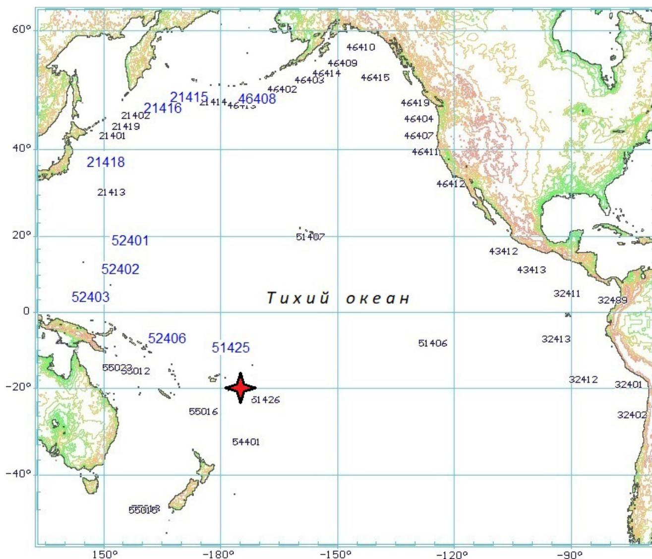
**Рис. 1.** Схема расчетной области. Звездочка – эпицентр взрыва. Пятизначные числа – положения станций системы DART. Синим цветом (более крупным шрифтом) обозначены станции, зарегистрировавшие как барическую, так и гравитационную волны.
