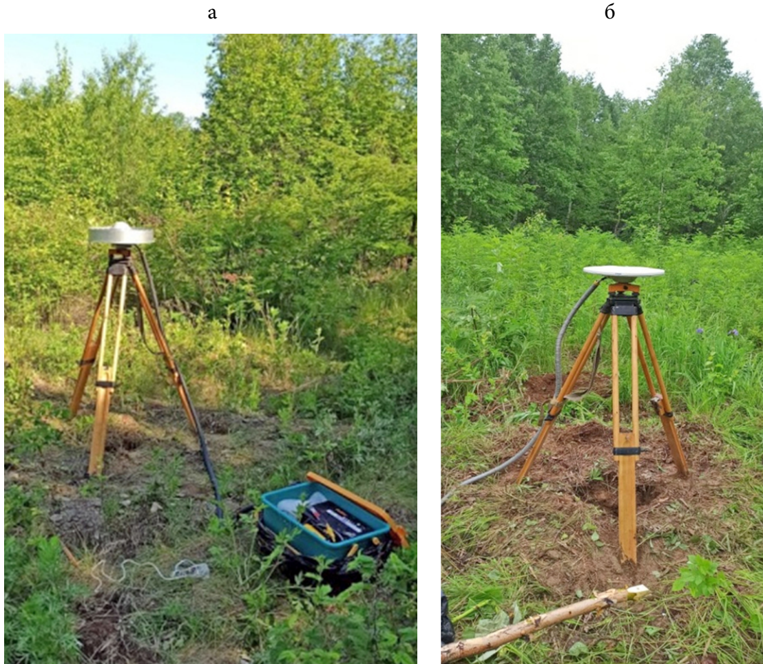
Рис. 3. GNSS наблюдения в 2023 г.: а – на пункте PERV с антенной ChokeRing; б – на пункте ZIMN с антенной Zephyr Geodetic. Fig. 3. GNSS observations in 2023: (a) at PERV point with ChokeRing antenna; (b) at ZIMN point with Zephyr Geodetic antenna.
