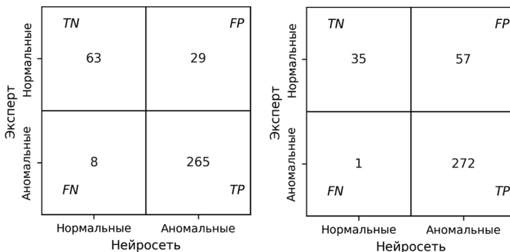
Рис. 10. Матрица ошибок бинарного классификатора для данных по станции Ак-Суу за 2019 г. Слева – порог 0.087 ( \mu + \sigma ), справа – порог 0.109 ( \mu + 2\sigma ).
