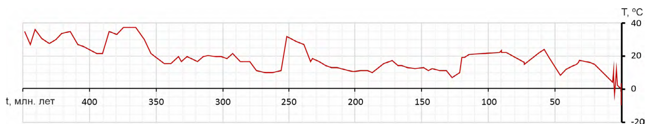
Рис. 2. Верхнее граничное условие параметрической модели – вековой ход температур земной поверхности на юго-востоке Западной Сибири.
