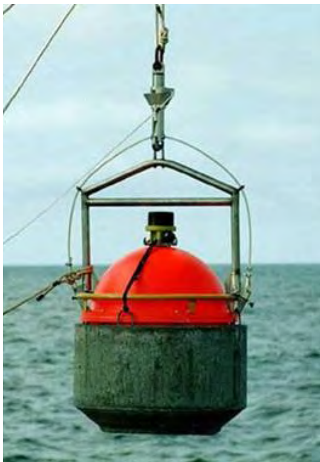
Рис. 4. Общий вид самовсплывающей АДСС, подготовленной к постановке.
