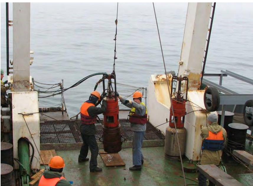
Рис. 5. Подготовка к работе пневмоисточника СИН-6М с камерой 80 л.
