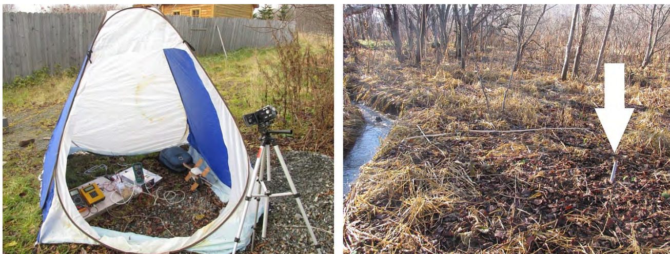
Рис. 3. Источник электроимпульсов и измерительная аппаратура, используемая на втором и третьем этапах эксперимента (слева). Стрелка указывает на электрод 1. 15 ноября 2021 г. Фото И.П. Дудченко
