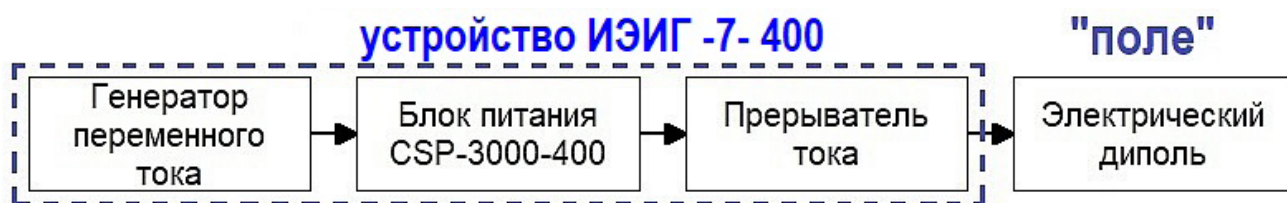
Рис. 2. Структурная схема источника электроимпульсов ИЭИГ-7-400, использованного при электрозондированиях в периоды 15–18 ноября 2021 г. и 25–28 апреля 2022 г.
