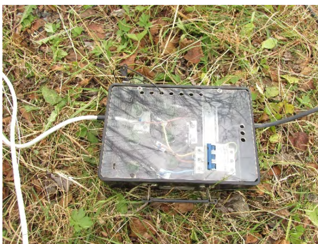
Рис. 4. Внешний вид трехфазного выпрямителя – источника тока в электрoзондированиях 7–10.11.2022 (слева). Регистрация тока 13 А на вольтамперметре в момент отдельного импульса (справа).
