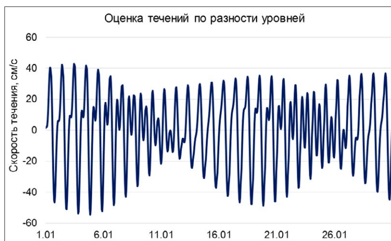
Рис. 7. Вариации скоростей приливных течений, рассчитанных по разности приливных колебаний уровня в точках TP735732 и TP497996 по предвычислению на январь 2026 г.
