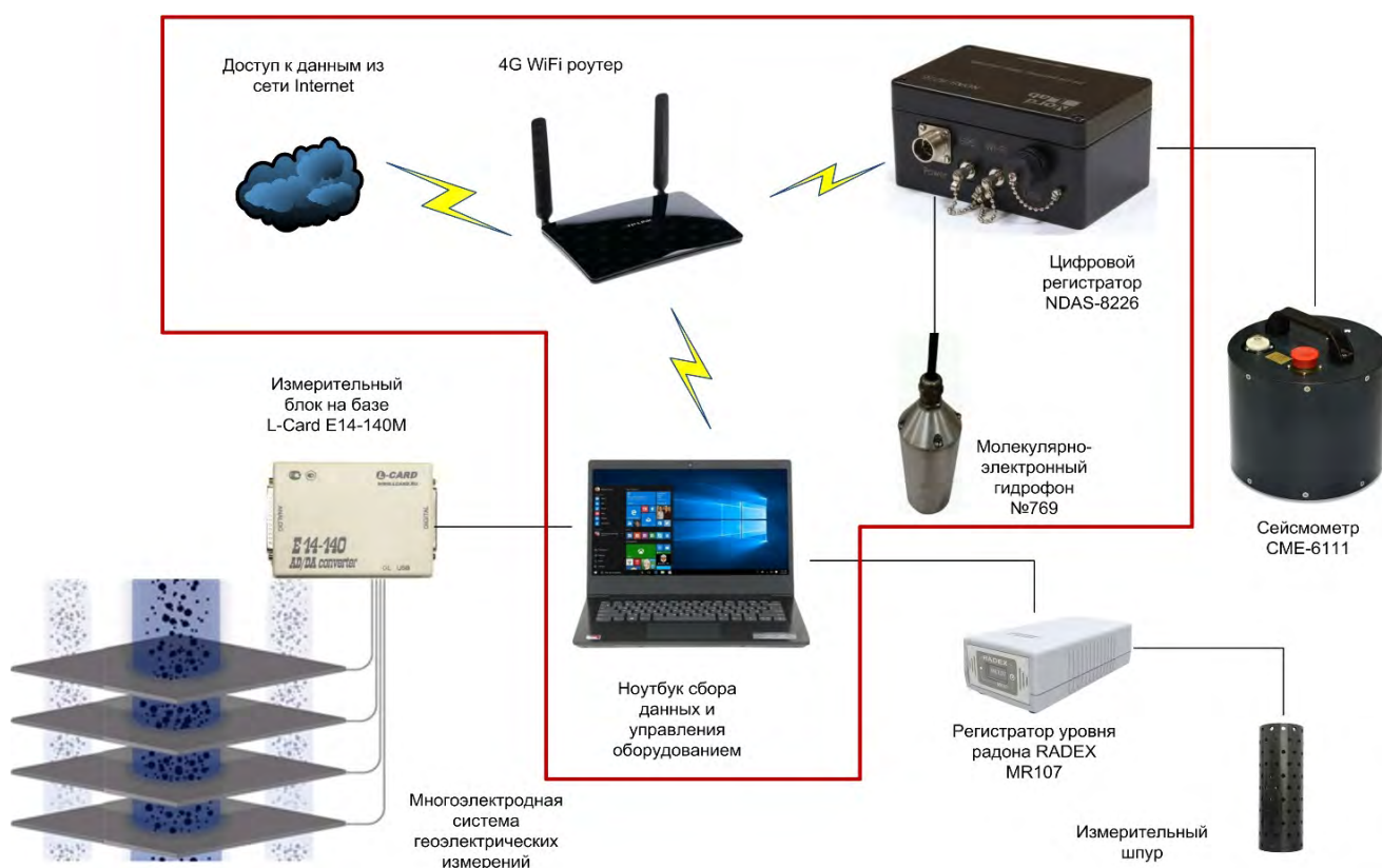
Рис. 4. Оснащение комплексного геофизического полигона «Петропавловское». Красной рамкой выделено оборудование для сейсмоакустических наблюдений.
