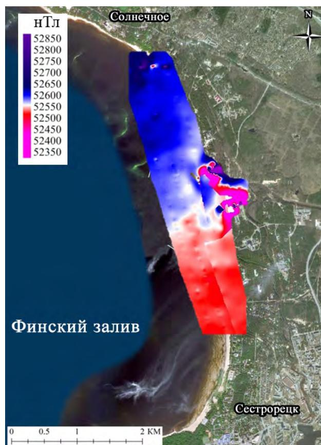
Рис. 4. Результат магнитной съемки (в том числе ледовой).
