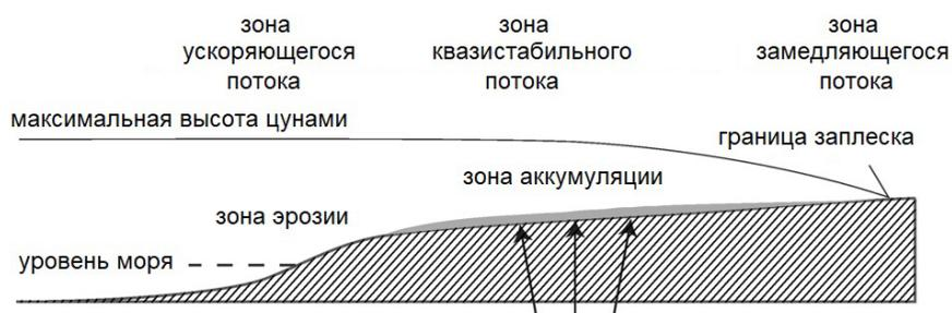
Рис. 2. Схематическое положение зон эрозии и аккумуляции материала в зоне воздействия прямого потока цунами по [Jaffe, Gelfenbaum, 2007].
