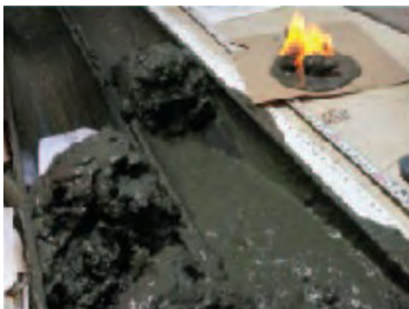
Рис. 20. Фрагменты газогидратонасыщенного керна осадка из осевой зоны Южно-Татарского прогиба.
