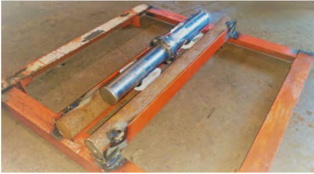
Рис. 2. Технологический образец крепежной рамы с регистратором волнения АРВ-К14-1 (в незакрепленном виде, без буйрепа и буя).
